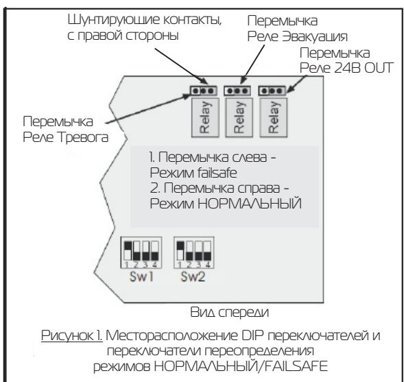
2. Настройки DIP переключателей, таймера эвакуации. DIP переключатели Sw1 управляют периодом времени в Автоматическом режиме (Auto), через которое панель перейдёт от сигналов Тревоги к сигналам Эвакуации. Этот период варьируется от 30 секунд до 7,5 минут с шагом в 30 секунд. Для настройки DIP переключателей, обратитесь к Таблице 1 и Рисунку 1. (Sw1). Обратите внимание, что эта таблица находится на внутренней стороне корпуса устройства. Заводская установка – 30 секунд.
